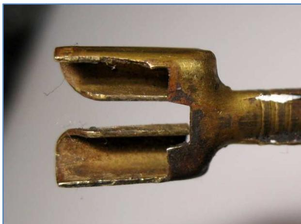
En effet, à chaque « chahutage » des fils du connecteur, le contact de la cosse était rétabli provisoirement.
