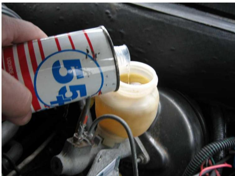
Lorsque le Lockheed sortant de la purge est bien clair et sans bulle, fermer la purge, placer le bouchon de purge, vérifier le niveau de Lockheed et revisser le bouchon sur le réservoir.
