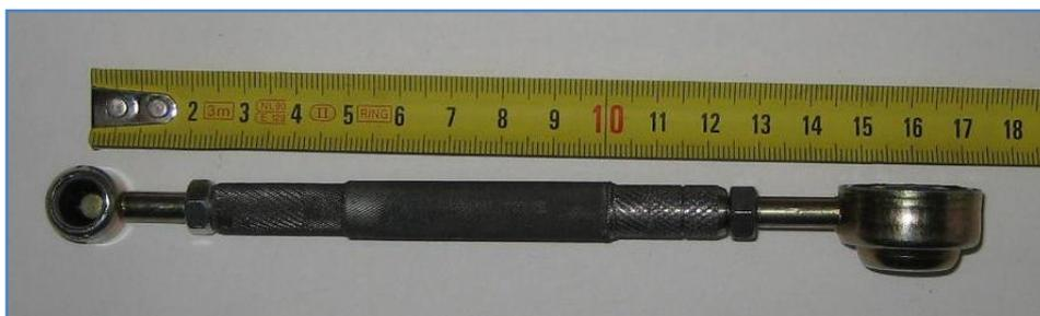
On coupe, on effectue un filetage sur les tiges, un taraudage dans le tube, on visse, on ajuste à la bonne longueur et à l'angle correct et c'est fait.
