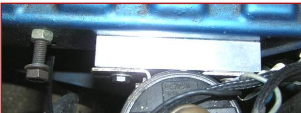
Augmenter le diamètre des trous de fixation d'origine pour monter l'ensemble du sandwich avec des vis, rondelles et écrous diamètre 6mm.
