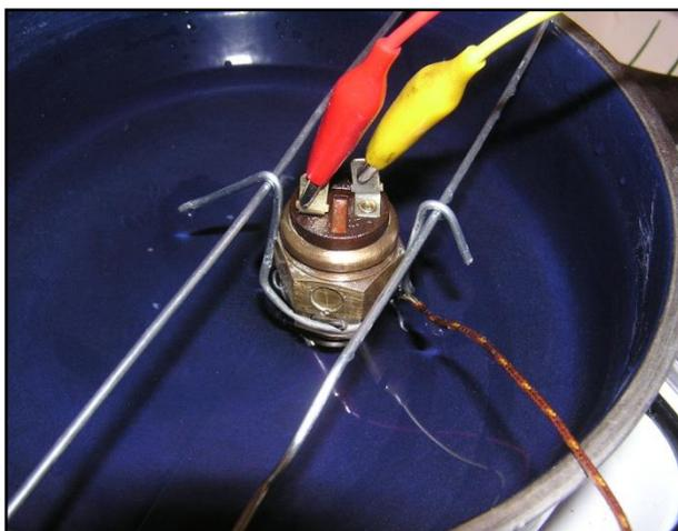
Brancher un ohmmètre sur les cosses ou une lampe témoin avec une pile en série.
