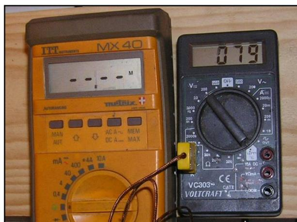
Laisser refroidir, le contact doit se couper entre 78 et **79**°.
