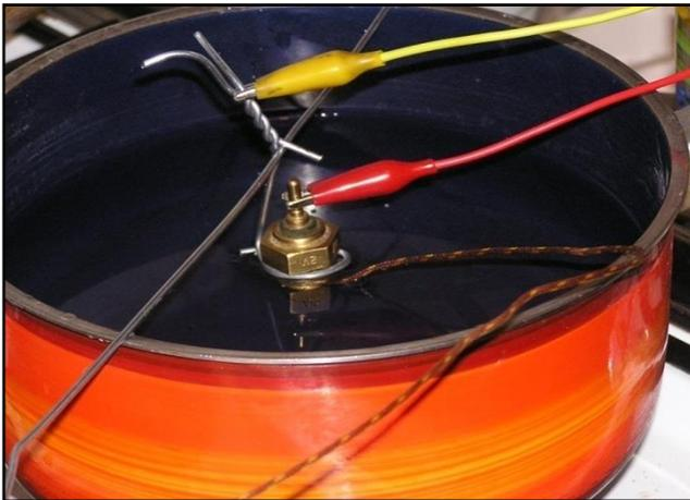
Brancher l'ohmmètre (pas de sens), placer le capteur du thermomètre dans l'eau, près de la sonde. Faire chauffer lentement. Les valeurs doivent être sensiblement les suivantes:
