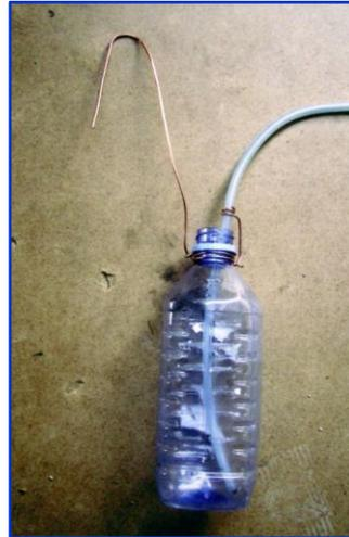
Une extrémité du tuyau doit être positionnée au fond du récipient, le maintenir avec du fil rigide.
