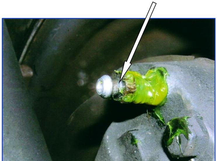
Retirer le bouchon de purge, brancher le tuyau sortant du récipient sur la purge.
