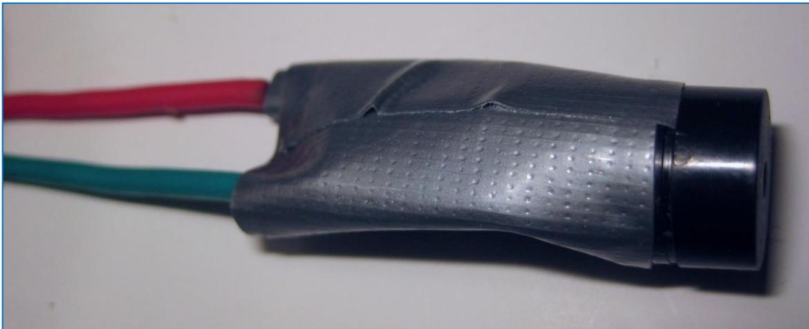
La réalisation est très simple. La résistance et le condensateur sont branchés car ce buzzer est un modèle 5 volts que j'avais sous la main, idéalement il faudrait prendre un modèle 12 volts.
