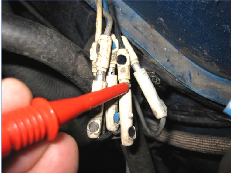
Dans la plupart des cas, les 12 volts sont présents mais la mesure sur les fiches noires, c'est à dire la masse où il devrait y avoir une tension proche de « 0 », il y a une tension supérieure à 3 volts.
