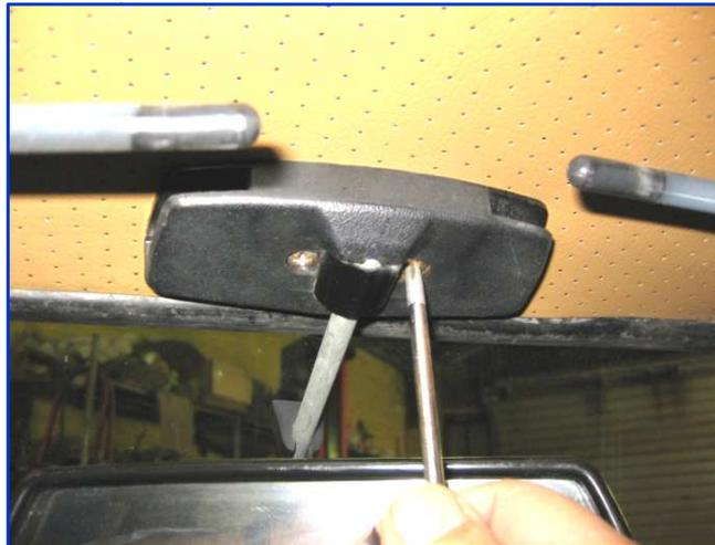
Avec le tournevis plat, tenu fermement, replier la lèvre intérieure du joint, pour la passer vers l'extérieur, juste sur la tôle de l'encadrement.
