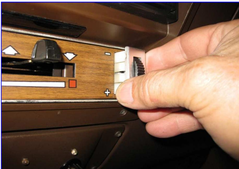
Repérer le sens du cache de fixation et le démonter à l'aide de 2 épingles ou 2 tournevis très fins, pour dégager les ergots.
