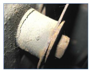
Par chance, les pièces sont simples et il est facile de trouver un produit similaire, chez les fournisseurs pour l'industrie. Il ne sera pas nécessaire d'effectuer une refabrication, comme ce fut le cas, pour les silentblocs du train avant, des supports du moteur et de boîte.
