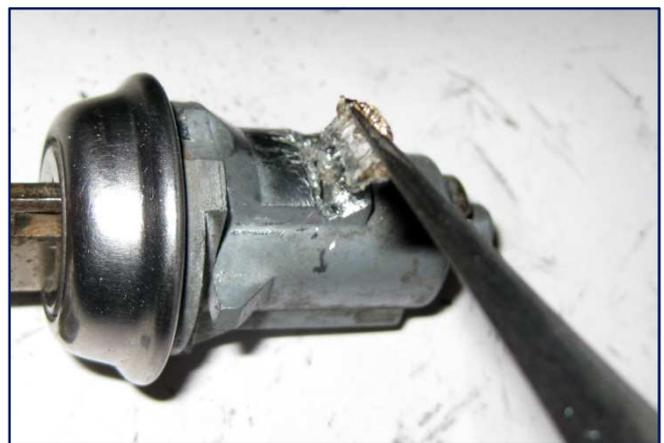
Une fois l'opération réussie, la clé, toujours dans le rotor, pousser le téton de commande et tirer l'ensemble, vous constatez que les languets ne sont pas au bon niveau, puisque la clé ne correspond pas.
