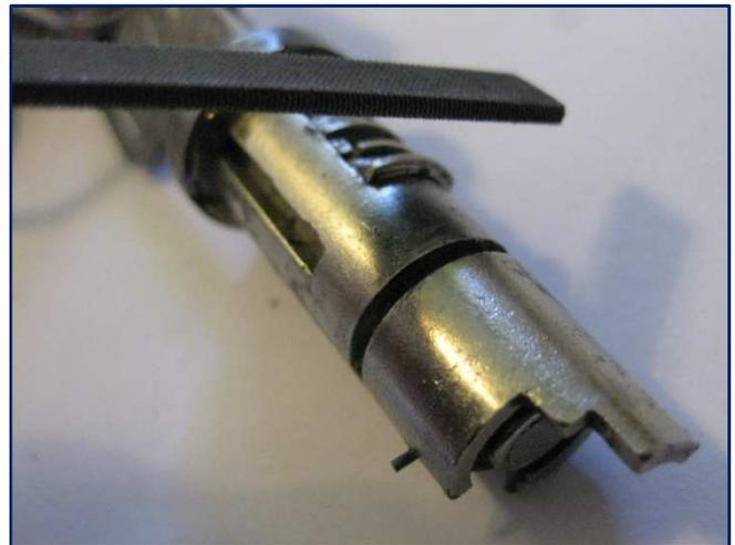
Avec une lime douce, il suffit de retirer ce qui dépasse du rotor.
