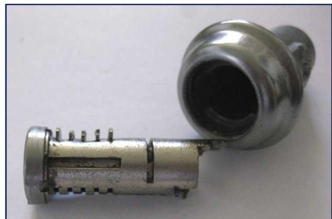
nettoyer l'ensemble des pièces et remonter avec un soupçon de graisse neutre.
