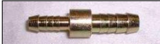
Le tube de diamètre de 6 mm rentre dans le tube de 8 mm, une soudure ou brasure et le tour est joué. L'alimentation électrique de la pompe est nécessaire, seulement pour amorcer le circuit d'essence.
